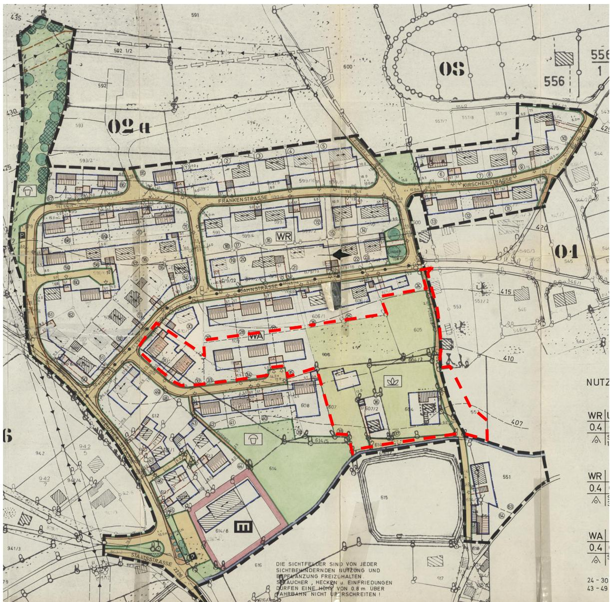
Abbildung 2: Ausschnitt des ursprünglichen Bebauungsplans aus dem Jahr 1977 mit Kennzeichnung des vorliegenden Änderungsbereichs
