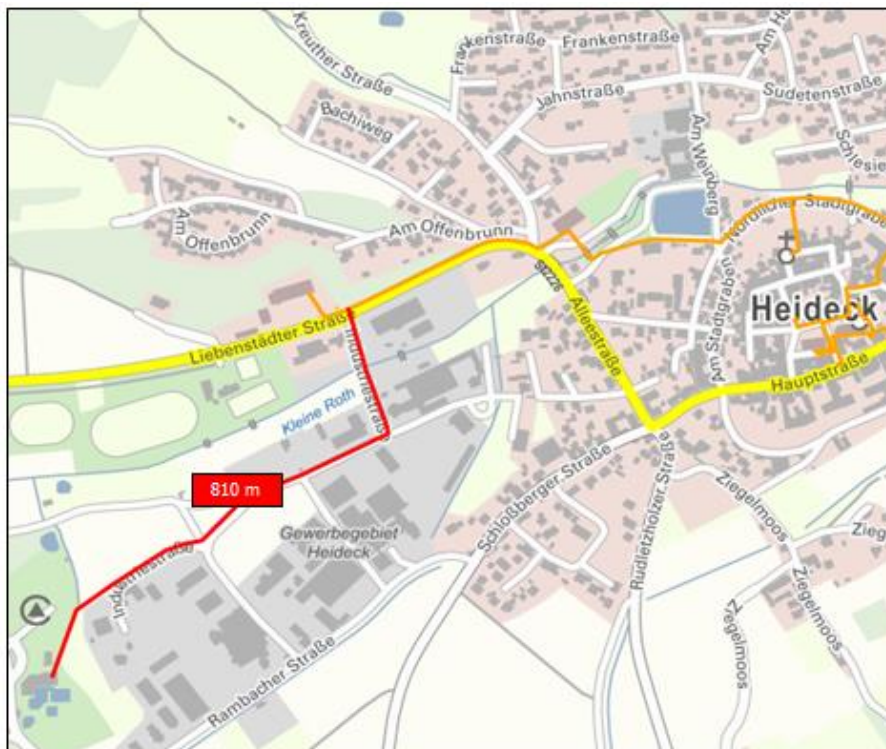
Abbildung 9: Das Nahwärmenetz zum Freibad, Netzvariante V
